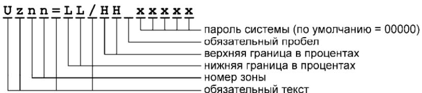
Границы задаются в процентах от максимального значения (равного напряжению на клеммах аккумулятора).
