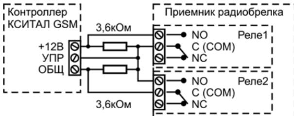
Напряжение на входе "Управление" (если это разрешено в настройке **Управление** на SIM-карте) однозначно определяет режим (0В - на контролле, +12В - контроль снят, +6В - пассивное состояние входа).
