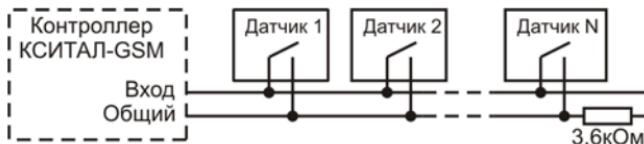
Датчики, контролирующие входную дверь или помещение за входной дверью (прихожую), необходимо подключать к зоне №1, имеющей программируемую задержку на срабатывание.
