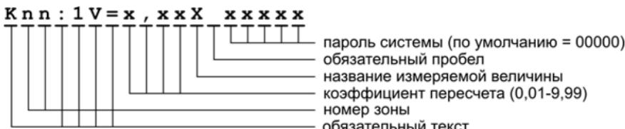
Например, если к 4-му входу подключен аналоговый манометр и 1 Вольт на входе соответствует давлению в 2,43 атм, то следующее SMS:
