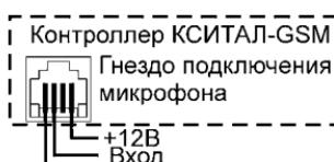
При необходимости к входу этого микрофона может быть подключен еще один микрофон "Кситал-МК". В такой цепочке допускается соединять до 3 шт. микрофонов "Кситал-МК", которые будут работать одновременно.
