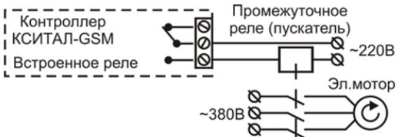
Если необходимо управлять мощными устройствами, то следует использовать промежуточные реле или контакторы соответствующего типа.
